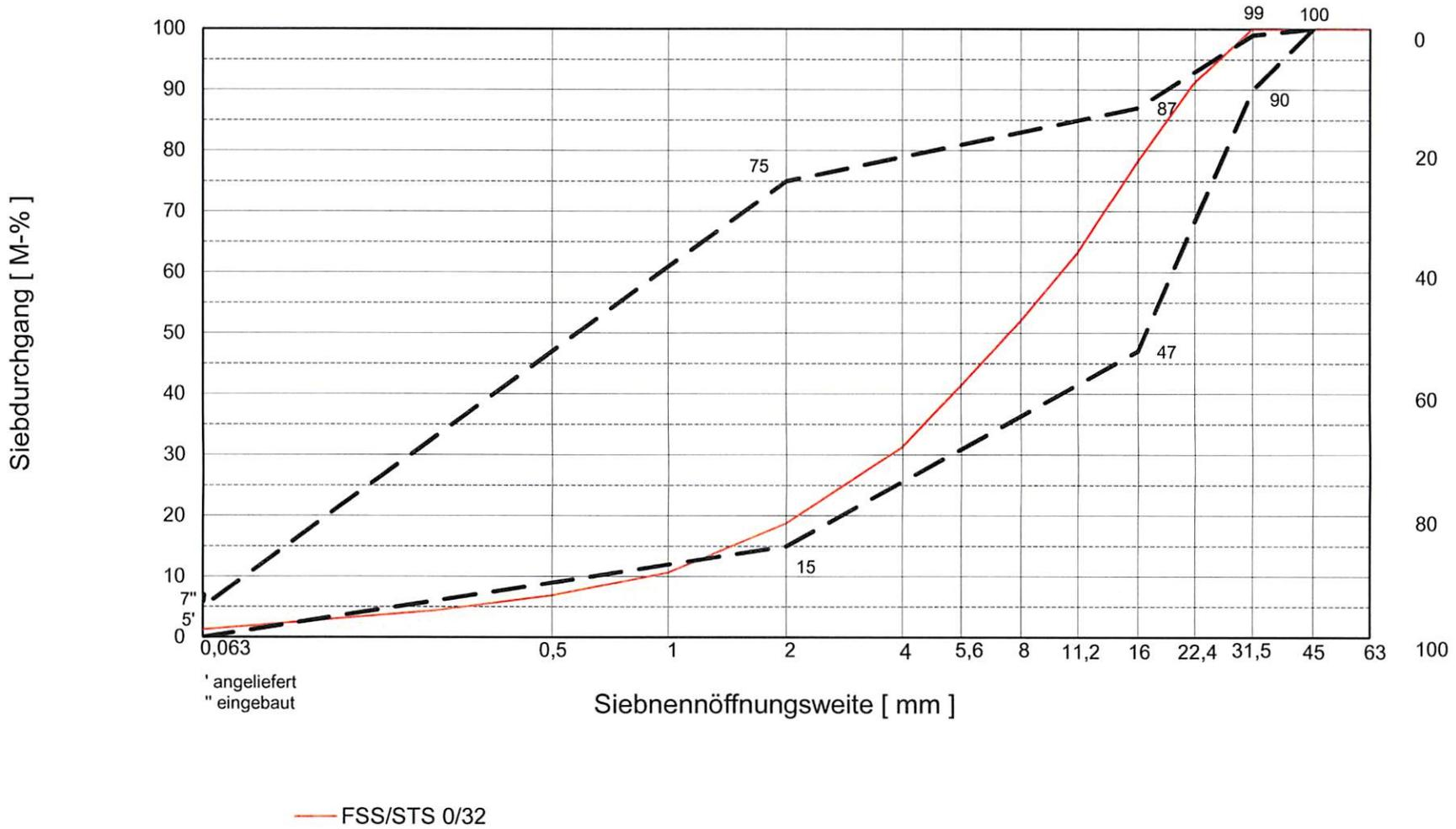
Sieblinienbereich für Baustoffgemische 0/32 mm für Frostschutzschichten nach TL SoB-StB 20 bzw. ZTV SoB-StB 20
