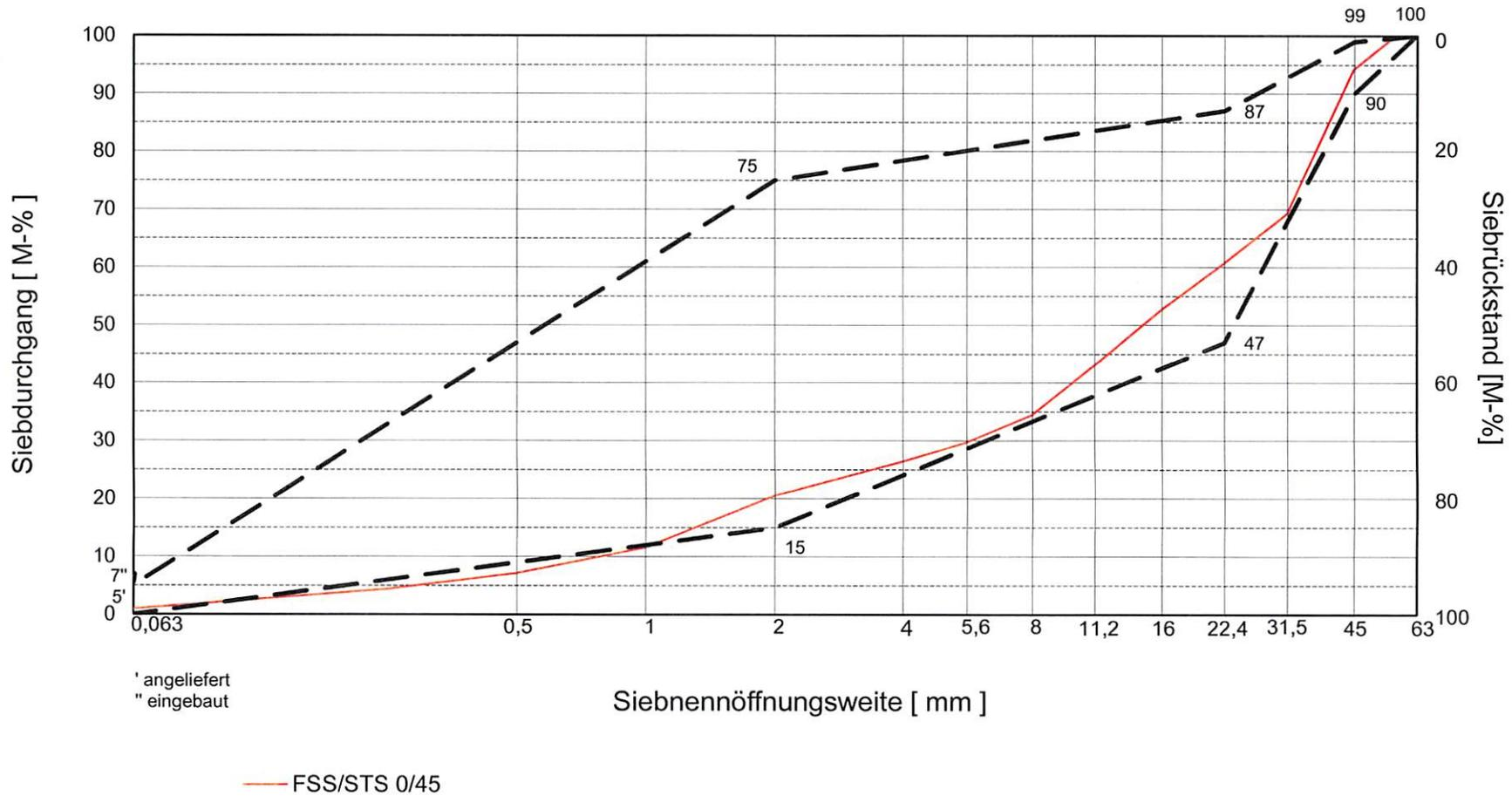
Sieblinienbereich für Baustoffgemische 0/45 mm für Frostschutzschichten nach TL SoB-StB 20 bzw. ZTV SoB-StB 20
